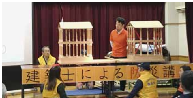
不適切な筋かい配置と適切な筋かい配置の耐震模型を加振
