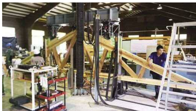
トラスの実験の様子（東予チーム：フィンクトラス）
