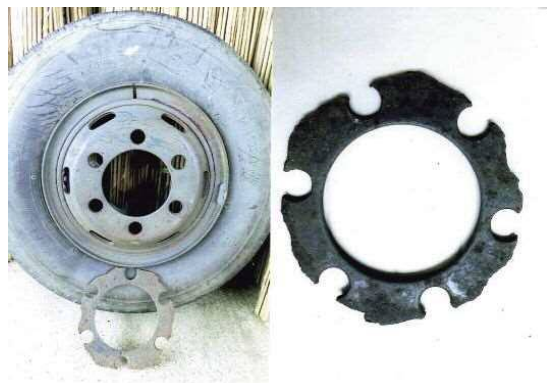
正常なホイールタイヤとボルトホールから千切れたホイール
