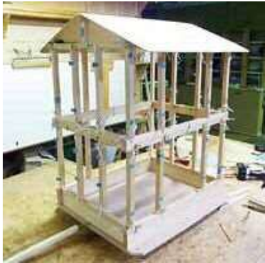
(補強をしていない状態の木造住宅倒壊模型)
