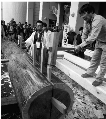
古代打割製材の実演：クサビを打ち込む
